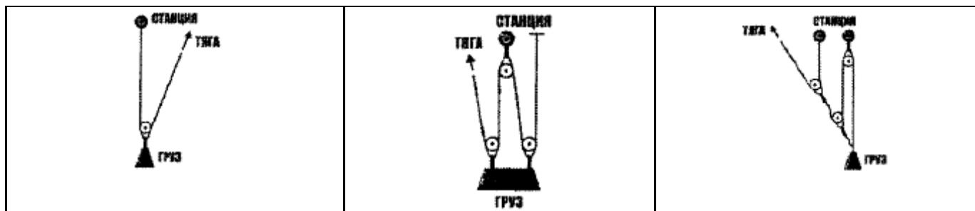
На грузовом канате выше тягового зажима должен быть установлен зажим для ограничения обратного хода конца каната, на котором закреплен груз. В плане производства работ с учетом оценки рисков может быть разрешено использование вместо зажима самозатягивающегося узла.
